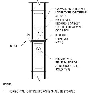
EACH SIDE OF CONTROL JOINT. TIE BEAM REINFORCING
